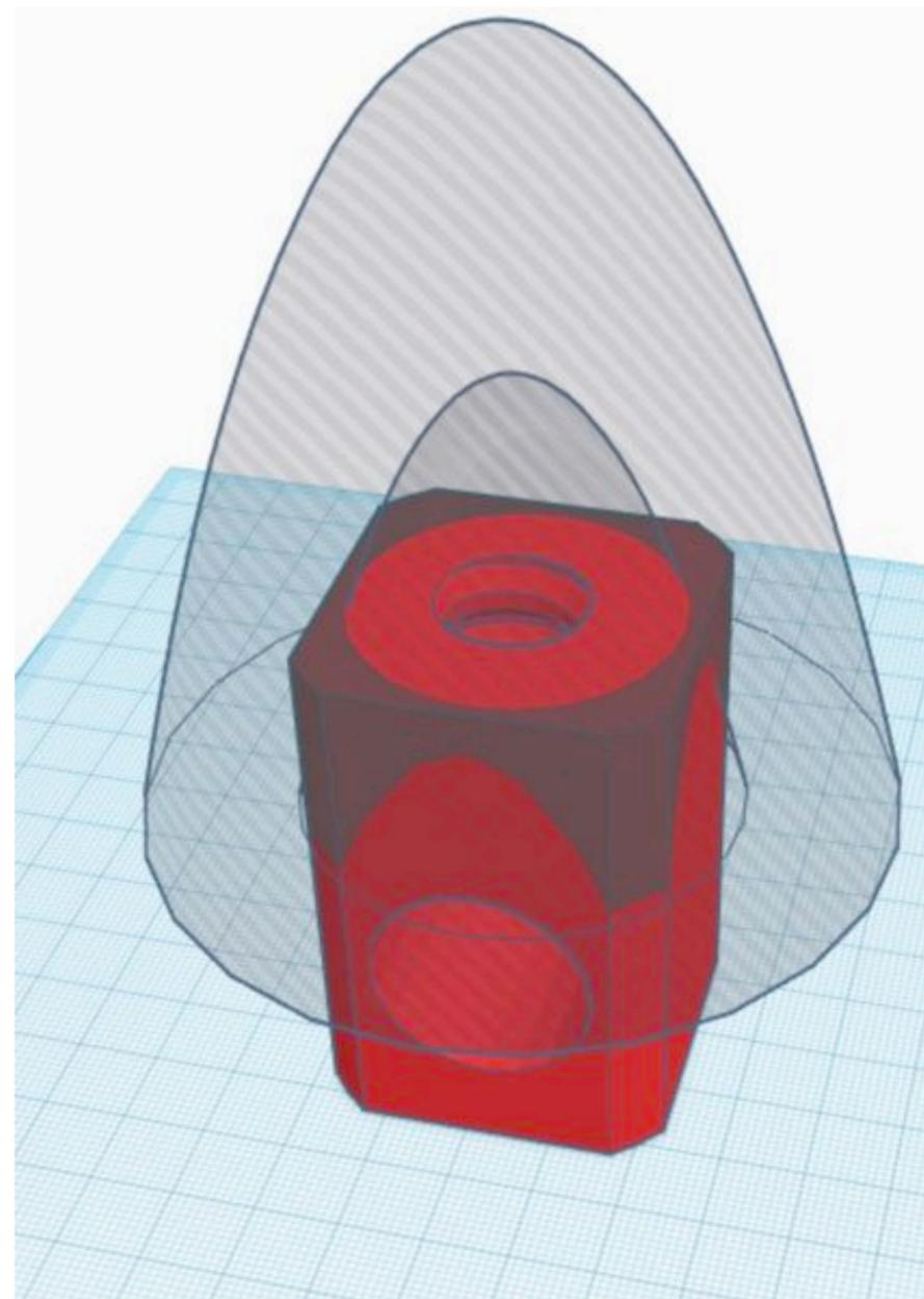
Arrondir les angles sur le dessus en réalisant un volume avec 2 paraboloides dont vous choisirez les dimensions.
